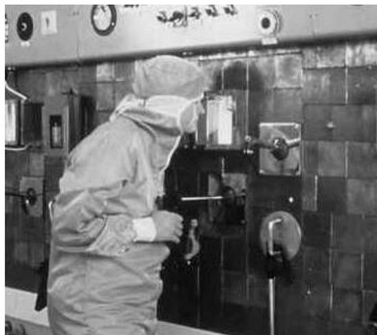
Forschungsreaktor zur Produktion von therapeutisch verwendeten Radionukliden (links, kommerzielle Verarbeitung von Radionukliden für die medizinische Anwendung in sog. heißen Zellen (rechts)
